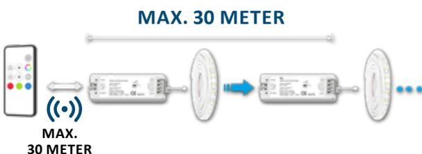
Eine Fernbedienung kann beliebig viele Empfänger ansteuern sofern sich diese im Sendebereich der Fernbedienung befinden. Vorausgesetzt die Empfänger erhalten nach durchgeführter Kopplung das weitergeleitete Signal der Fernbedienung über dazwischen liegende Mesh-Transceiver.
